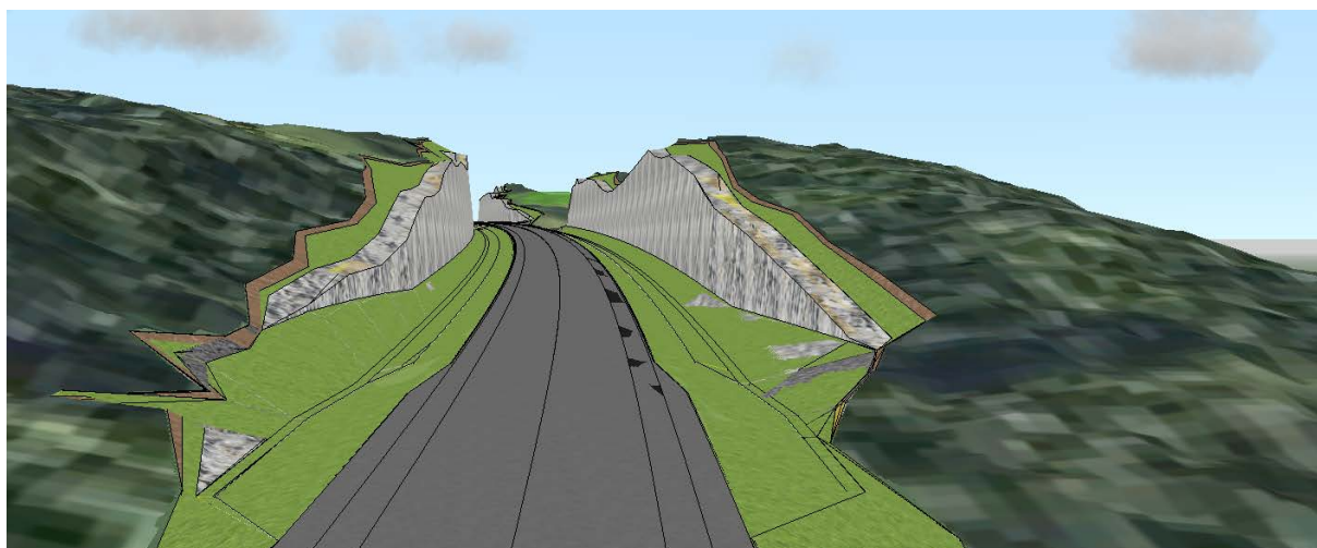
Figur 5.9 Det er gjort konkrete vurderinger og ulike tiltak for å dempe ned de visuelle virkningene av bergskjæringene og for å øke bilførerens oversikt til terrenget etter skjæringene. Der det ligger til rette for det er skjæringene «åpnet» i starten og slutten for lettere å kunne oppdage kryssende vilt.
