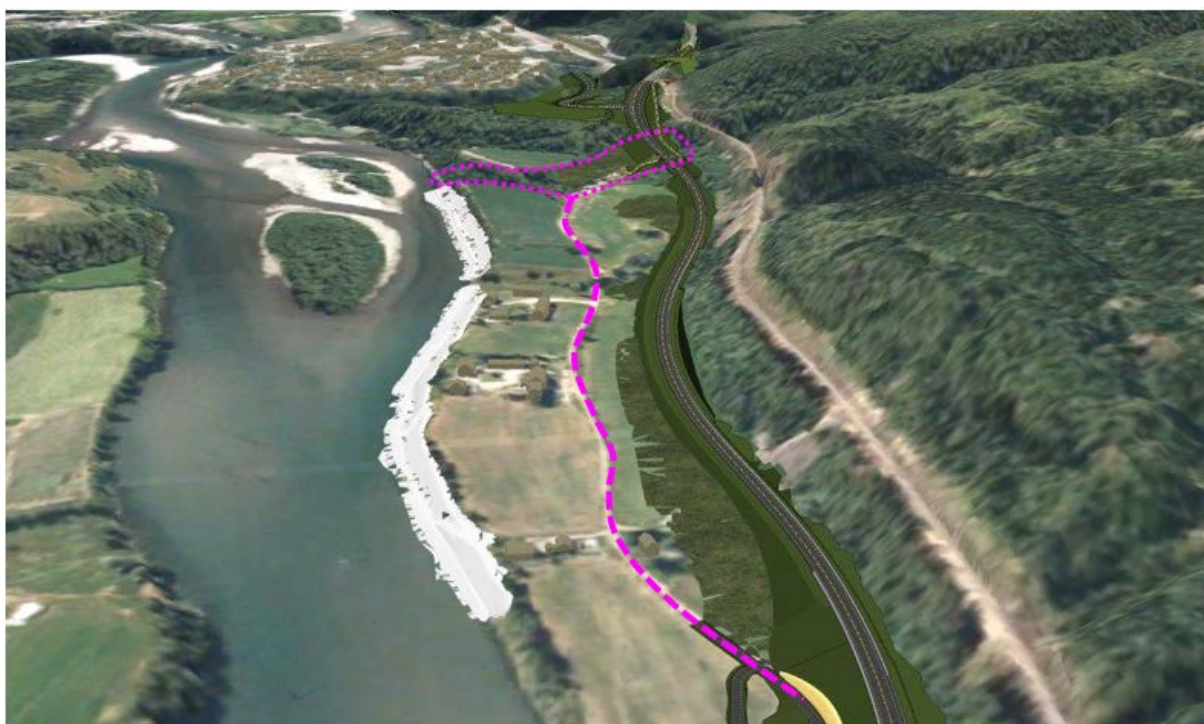
Figur 5.13 2013-planen ville medført omfattende inngrep i Nedre Svenningdal. Både visuelt, omfangsmessig og med økonomiske følger for dem som bor der. I praksis ville all dyrka mark mellom kommunal veg og lisiden blitt berørt. Enten i form av tapt areal under veg og fyllinger. Eller som følge av ombygging av dyrket mark, og langtidsvirkninger mht. arealenes produksjonsevne. Gårdene og bomiljøet ville også blitt sterkt berørt av store inngrep på
