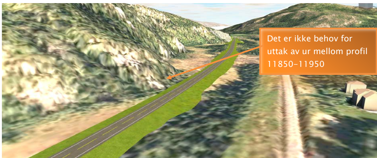
Figur 7.3 Det er ikke behov for uttak av ur mellom profil 11850–11950
